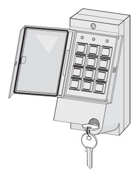
Allgemeines: Die Codetastatur in Verbindung mit der Eingabeeinheit ermöglicht eine Scharf-/Unscharfschaltung der Einbruchmeldeanlage erst nach Eingabe der richtigen Zahlenkombination an der Codetastatur. Bei der Bedienung zur Scharf-/Unscharfschaltung wird erst der Smart-Key Schlüssel eingesetzt und dann der Benutzercode.
